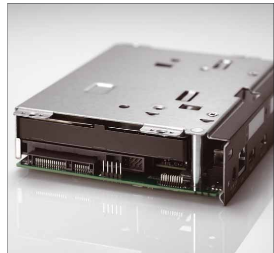
Die geringe Gerätegröße verlangt enges Zusammenspiel der Komponenten, die in einem stabilen Metallrahmen untergebracht sind
