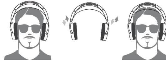
**Ohrpolsterwechsel** Zum Wechseln verschlissener Ohrpolster ertasten Sie den Haltering innen am Rand. Drücken Sie mit dem Daumen von außen dagegen, bis Sie mit dem Daumen unter das vorgelöste Ohrpolster kommen. Ziehen Sie jetzt das gesamte Ohrpolster von der Muschel.
